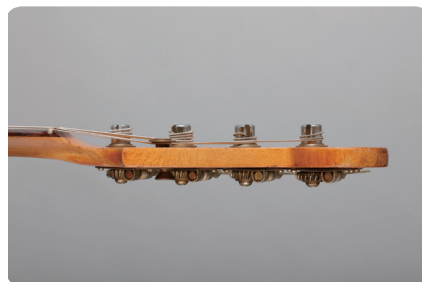
写真6：指板面とヘッド面の段差は10~12mm程度のものである。
