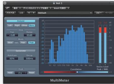
複数のメーターを装備したプラグインです。マスターチャンネルなどにインサートしておく便利です。中央の大きなエリアは、1/3オクターブの周波数ごとにレベルを表示するAnalyzerもしくは、ステレオイメージを表示するGoniometerに切り替えられます。また、上記のCorrelation MeterとLevel Meterも装備します。
