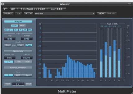
サラウンドトラック用のMultiMeterです。チャンネル数が増えているほか、GoniometerとCorrelation Meterはサラウンドの各チャンネル間の相関を見られるようになっています。
