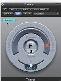
チューニングメーターです。中央のエリアに音名が表示されます。基準ピッチは410.0-470.0Hzの間で設定できます。
