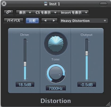
トランジスタ式のクラシックなディストーションです。ファズのような鋭いサウンドが得られます。Driveを上げればより歪みが増大します。Toneで高域をカットして柔らかい音色に調節できます。サウンドのイメージが円内にグラフィカルに表現されます。
