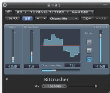
デジタル処理によるレベルオーバーをあえて起こさせたり、ビット数やサンプルレートを落としたりします。初期デジタル製品のようなザラついた質感や、デジタルならではの破壊的なディストーションサウンドが作成できます。入力レベルと歪みやずさを決める、DriveとClip Levelで歪み(レベルオーバー)の度合いを決めます。歪み方(サウンド)は3種類のModeから選択します。
