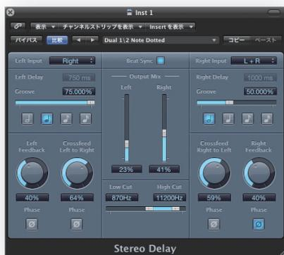
ステレオタイプのディレイです。左右に飛び回るようなディレイ効果や、空間に漂うような音場を演出できます。Beat Syncボタンをオフにするとテンポにシンクロしないディレイを作成可能です。オンにした場合は音符単位で設定でき、さらにGrooveで前後にずらせます。左右独立のFeedbackは、Crossfeedでたすきかけにかけられることも可能です。
